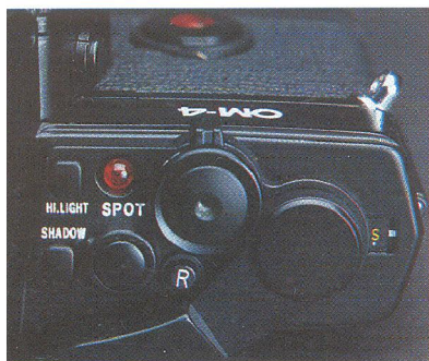
Spotmålingen på OM-4 indkobles legende let ved tryk på »SPOT«-knappen. Hvis det ønskes, kan det ledsages af diskrete beep-signaler.
